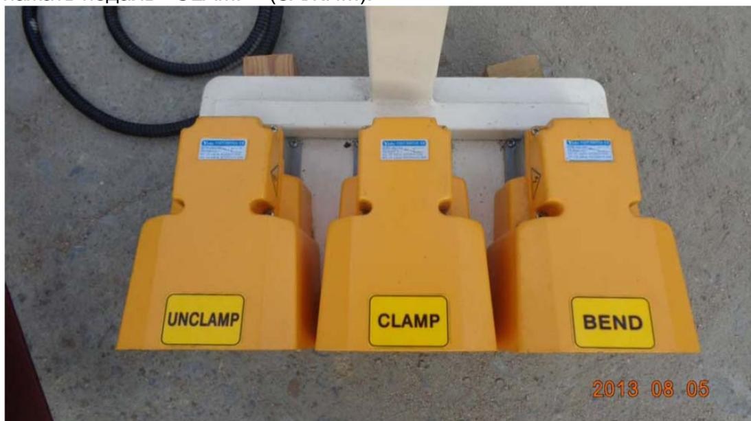
Установить указанный ниже переключатель в положение «BEND» ( ГИБКА), после чего гибочная балка поднимется и выполнит сгиб, затем установить переключатель в положение «RELEASE» (ОСЛАБЛЕНИЕ), после чего гибочная балка опустится, и захват будет ослаблен.
