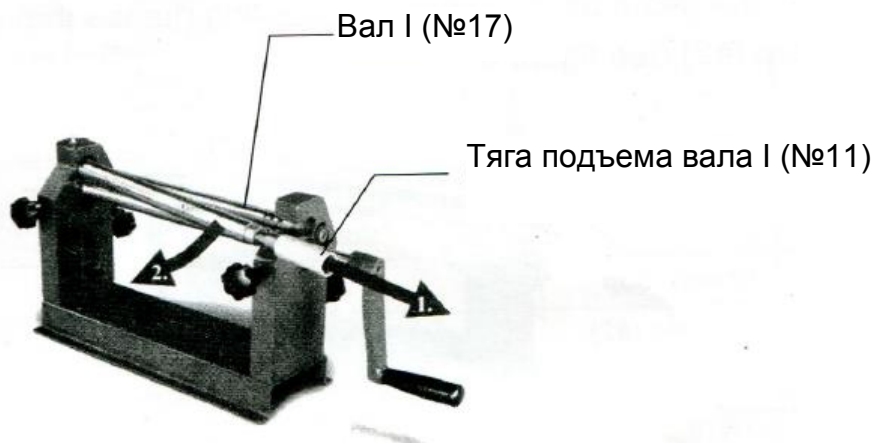
Рисунок 4 – Снятие незавершенного изделия
