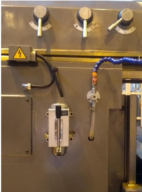
Рис. 17 Насос смазки стола
