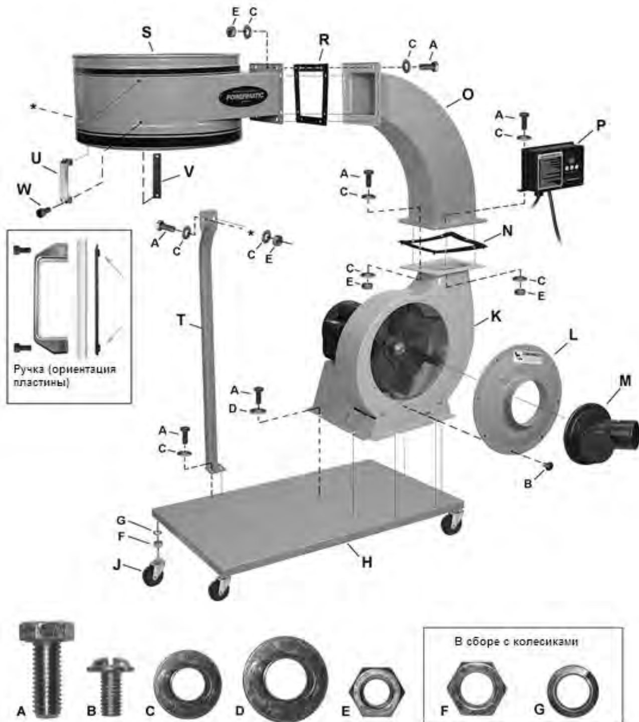
Рисунок 3: Идентификация элементов и порядок сборки
